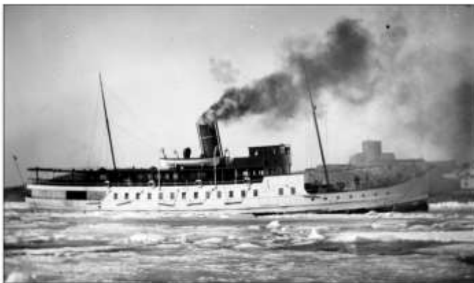
BOHUSLÄN passerar södra inloppet i Marstrand vintern 1922. Ångaren är rejält aktertrimmad för iygång. Vindskyddet på bryggan har tillkommit och under däck akterut finns bara fönsterventiler i aktersalongen. Foto Alvar Nilsson, Marstrand.
