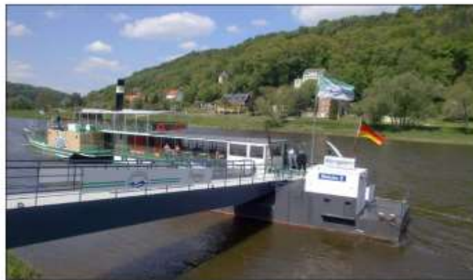
Vid tilläggningarna passeras pontonen varefter ångaren backar in till den. Detta för att vid avgång inte fastna med hjulhuset som sticker ut omkring tre meter. Königstein i Sächsische Schweiz. Foto 5 maj 2011 Ingvar Kronhamn
