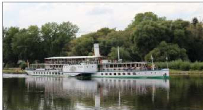
Hjulångaren LEIPZIG är yngst bland hjulångarna i Dresden, byggd 1929. Den är också längsta, 69,60 meter, nästan en meter längre än "system" Dresdens byggd 1926.
